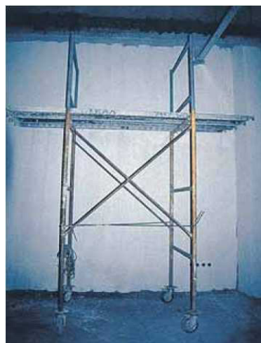
▲ Κινητή σκαλωσιά (πύργος) ανασφαλής. • Δάπεδο εργασίας χωρίς προστασία έναντι πτώσης. • Δεν υπάρχει σκάλα για ασφαλή ανάβαση - κατάβαση.
