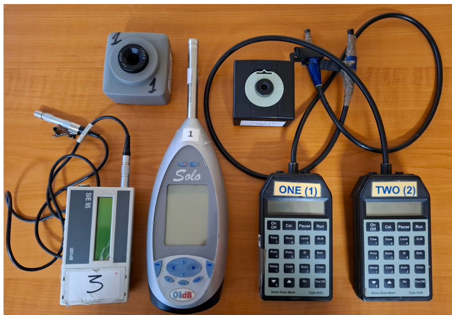
Εικόνα 2: Ηχόμετρο, ηχοδοσίμετρα και ακουστικοί βαθμονομητές για τον προσδιορισμό του θορύβου
