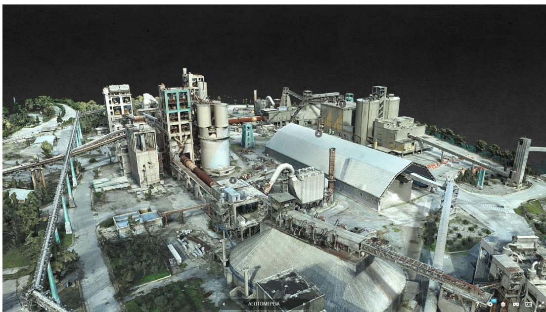
Εικόνα 1. Το τρισδιάστατο μοντέλο που προέκυψε από τη χρήση drones και laser scanners
