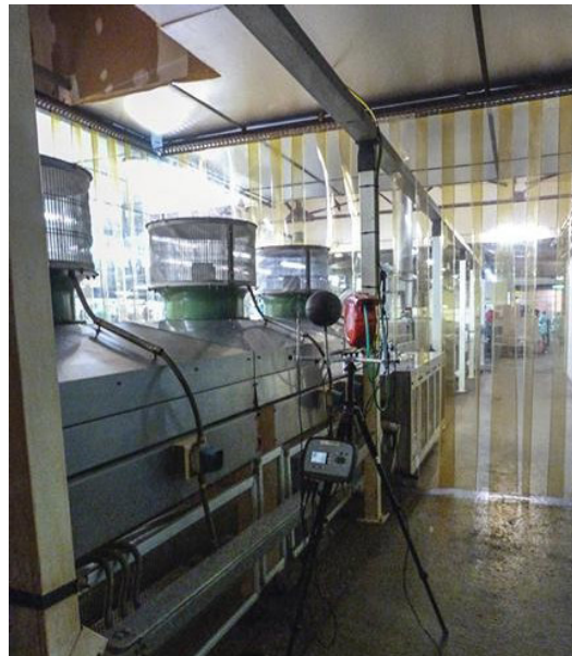
Εικόνα 4: Βιομηχανία μπισκότων με οθόνες PVC για την απομόνωση της ζώνης μαγειρέματος, Βιβλιογραφική πηγή 8, σελίδα 61
