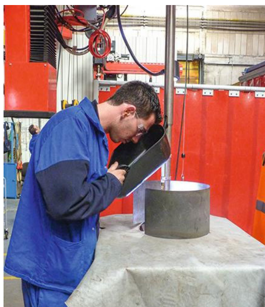
Εικόνα 5: Εργασία συγκόλλησης - τοποθέτηση πυρίμαχης υφασμάτινης σήτας σε μέρος που θερμαίνονται στους 380°C, Βιβλιογραφική πηγή 8, σελίδα 61
