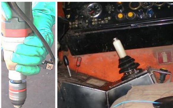
Εικόνα 1: Επιταχυνσιόμετρο προσαρτημένο στο χέρι χειριστή στη λαβή του εργαλείου χειρός για τον προσδιορισμό δονήσεων μεταδιδόμενων στο σύστημα άκρων χεριός-βραχίονα και επιταχυνσιόμετρο προσαρτημένο σε δονούμενο κάθισμα χειριστή για τον προσδιορισμό των ολόσωμων κραδασμών.
