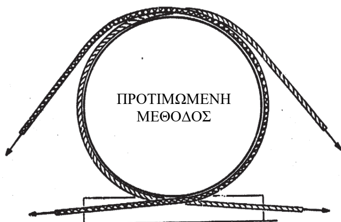
Σχήμα 1 Ασφάλιση δοχείων που δεν έχουν κανένα σημείο ασφάλισης
