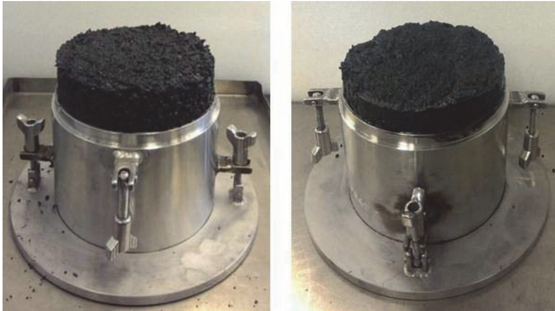
Εικόνα 1.5.7 Φωτογραφίες που δείχνουν έγκυρες δοκιμές για μερικώς κορεσμένο τμήμα δοκιμής (αριστερά) και τμήμα σχεδόν πλήρως κορεσμένου δείγματος (δεξιά)
