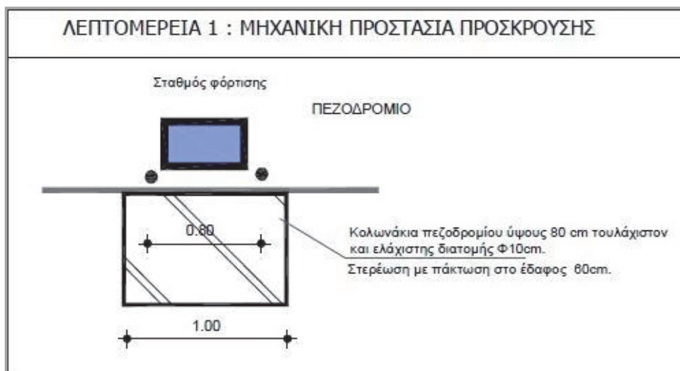
Εικόνα 1.γ: Λεπτομέρεια μηχανικής προστασίας.
