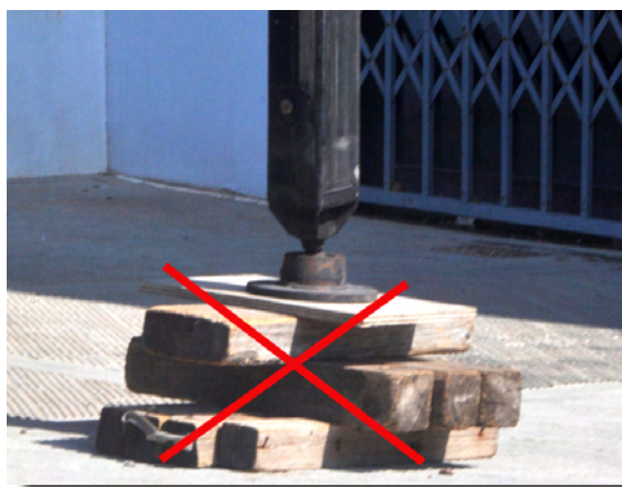
Εικόνα 6. Επικίνδυνη βάση στήριξης καθαθοφόρου ανυψωτικού.
