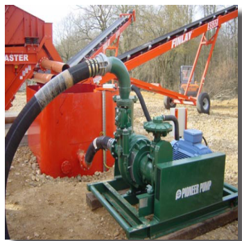
Από πάνω προς τα κάτω: αντλίες πολφού-λάσπης και φυγοκεντρικές Flygt, Gindex, Pioneer (mining technology.com)
