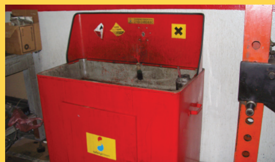
Εικόνα 8: Πλυντήριο εξαρτημάτων όπου χρησιμοποιούνται διαλύτες
