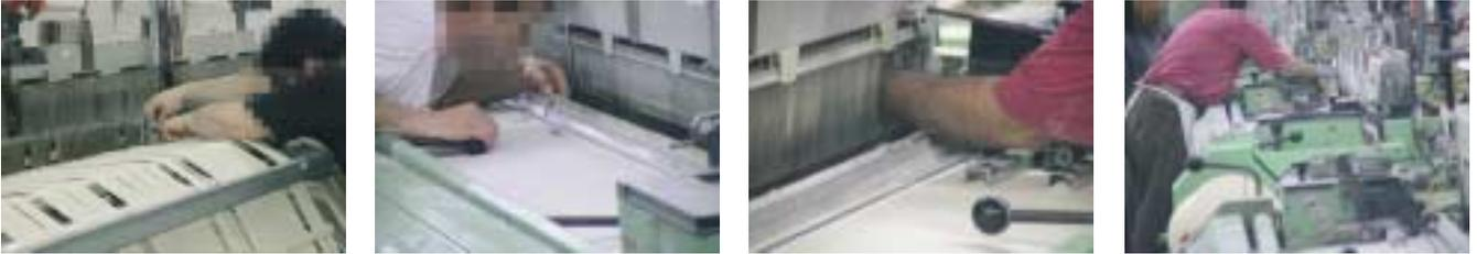
Σε κάθε περίπτωση πρέπει να υπάρχει σύστημα που να μην επιτρέπει την κίνηση όταν έχει πλησιάσει εργαζόμενος σε επικίνδυνο σημείο και να επιβάλλει αργή κίνηση μέχρι αυτός να βρεθεί σε ασφαλή θέση. Αυτό επιτυγχάνεται είτε με χρονοκαθυστερήση είτε με απαίτηση δεύτερης ενεργοποίησης του συστήματος για να αποκτήσει πλήρεις στροφές.
