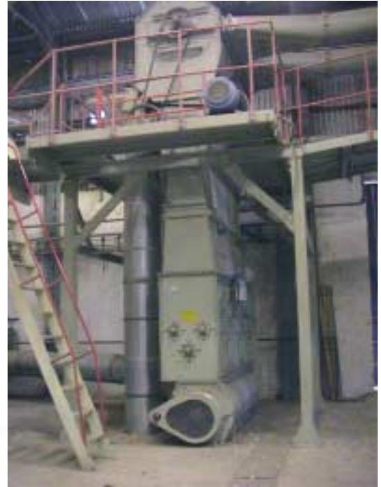
Όπως φαίνεται στο σχήμα το συγκεκριμένο μηχάνημα διαθέτει μεγάλο ύψος. Παρότι δεν απαιτείται η παρουσία χειριστή σε αυτό, η συντήρηση γίνεται σε ύψος και για το λόγο αυτό πρέπει να υπάρχουν κατάλληλα προστατευτικά μέτρα. Απαιτείται η τοποθέτηση και διατήρηση σε καλή κατάσταση προστατευτικών κιγκλιδωμάτων με σοβατεπί (κιγκλίδωμα ύψους 1m, με χειρολισθήρα, κουπαστή και στηθαίο 15 cm) για την αποτροπή πτώσεων εργαζομένων ή αντικειμένων στους εργαζόμενους που βρίσκονται κάτω.
