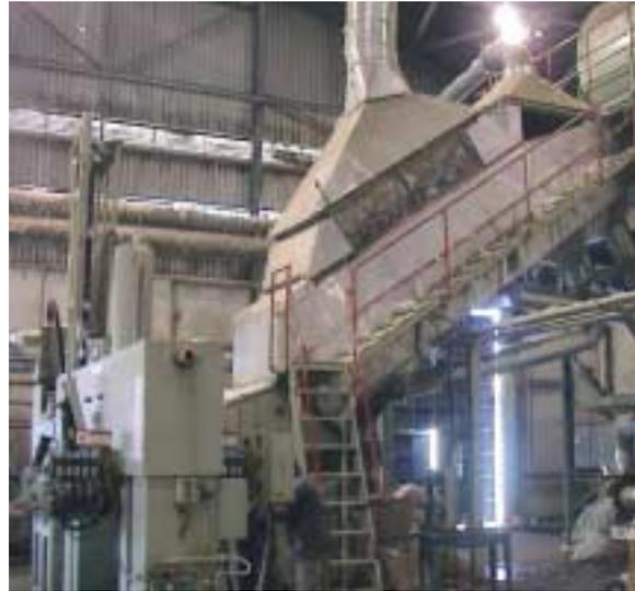
Χαρακτηριστικό του συμπυκνωτή είναι το μεγάλο του ύψος. Δεν χρειάζεται τη συνεχή παρουσία εργαζόμενου αλλά επιβάλλεται η τοποθέτηση μόνιμης διάταξης πρόσβασης (σκάλες και εξέδρα με κιγκλιδώματα και στηθαίο) για τον καθαρισμό και συντήρηση.
