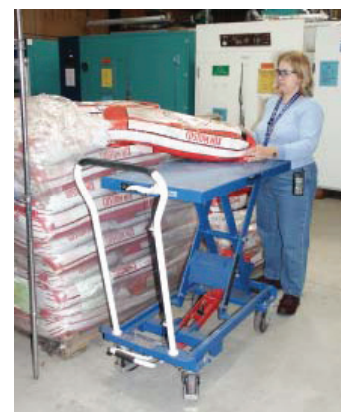
Εικόνα 11 Ψαλιδωτό τραπέζι για ρύθμιση του σωστού ύψους ανύψωσης.
