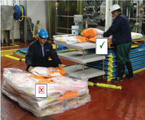
Εικόνα 7. Τα βαριά υλικά που ανυψώνονται συχνά, πρέπει να αποθηκεύονται στο ύψος της μέσης. Αποφυγή της αποθήκευσης στο πάτωμα.
