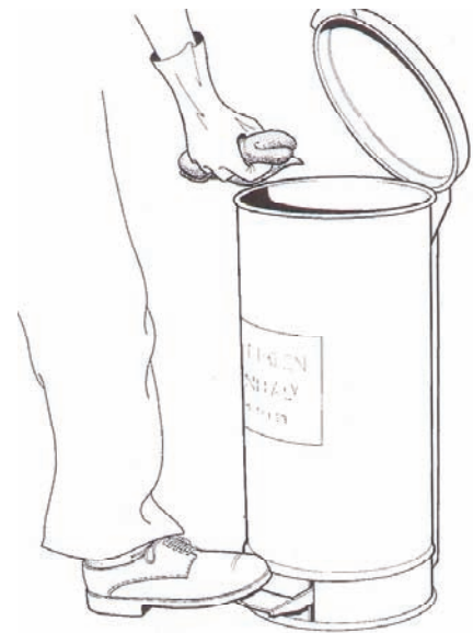
Εικόνα 18: Τα χρησιμοποιημένα υλικά καθαρισμού, ιδιαίτερα αυτά που περιέχουν εύφλεκτες ουσίες, πρέπει να απορρίπτονται με ασφάλεια και να απομακρύνονται από το χώρο εργασίας.
