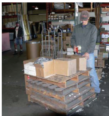
Εικόνα 10 Χρήση παλετών για την ανύψωση της επιφάνειας εργασίας.
