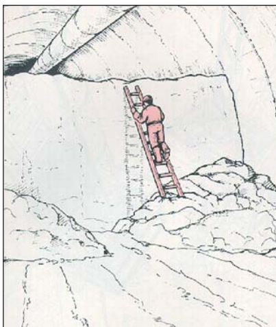
Φωτο 18: Σκάλα χωρίς και με προεξοχή 1 μέτρου μέσα σε σήραγγα
