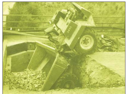
Φωτο 13: Ανατροπή μικρού τάμπερ λόγω έλλειψης στοπ στους τροχούς
