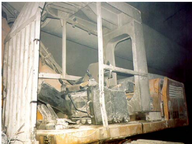
Φωτο 26: Καμπίνα μηχανήματος ανοικτή και σε κακή κατάσταση
