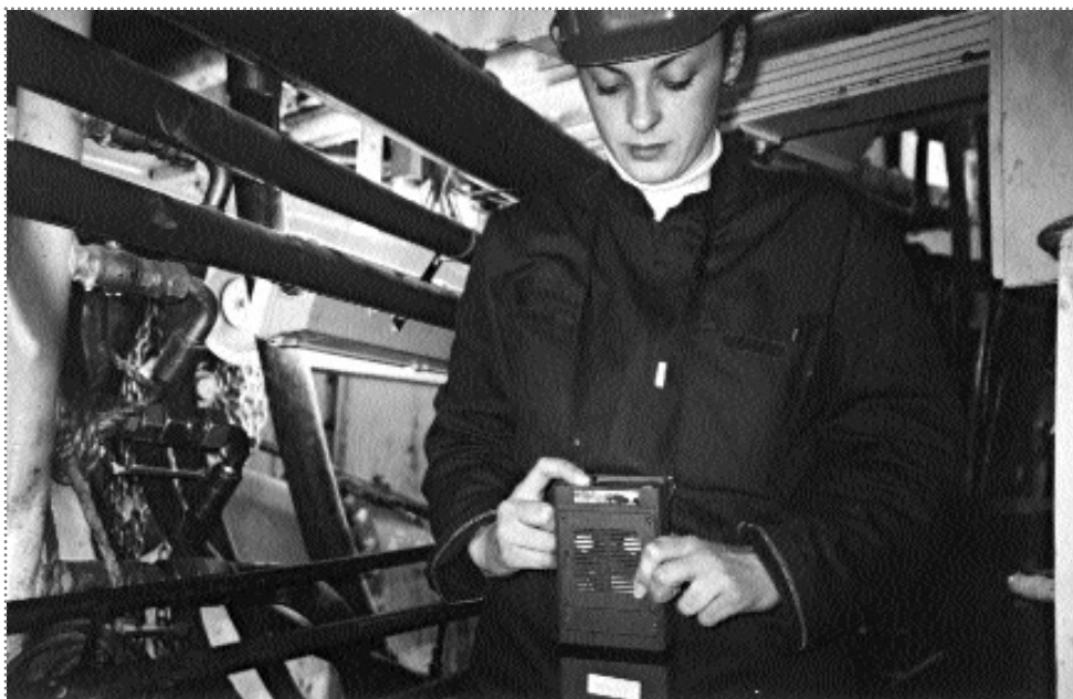
Χρήση φορητής συσκευής ανίχνευσης επικίνδυνων αερίων -O 2 από Μηχανικό Εργοταξίου Υπ. Έργου
