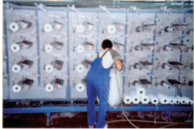
Εικόνα [2.4.3] 5: Καθαρισμός τμήματος μηχανής σχοινοποιΐας, όπου συλλέγονται σε ράφια τα καρούλια με το νήμα
