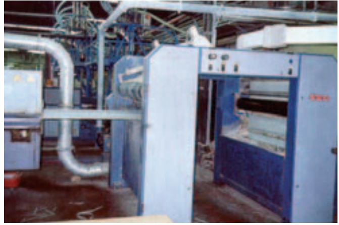
Εικόνα [2.4.3] 2: Μηχανή εξώθησης για την παραγωγή νημάτων
