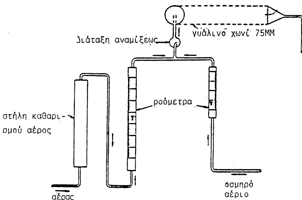
Σχήμα A.1 Συσκευή εκτιμήσεως της οσμής του υγραερίου
