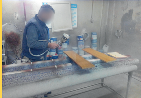
Εργασία βαφής χωρίς μέσα ατομικής προστασίας
