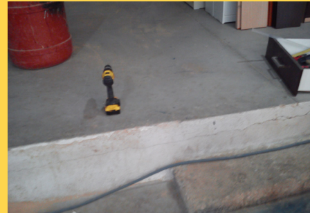
Εργαλείο χειρός στη μέση του χώρου με κίνδυνο πτώσης και τραυματισμού
