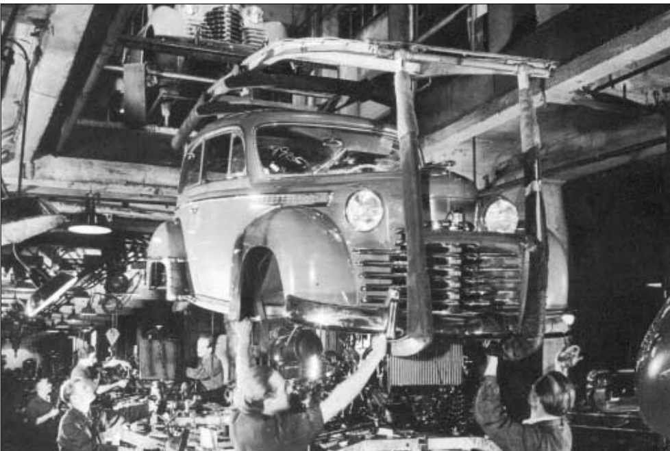
Εικόνα 2: Αλυσίδα συναρμολόγησης του μοντέλου Olympia στην αυτοκινητοβιομηχανία Opel το έτος 1957 (φωτογραφία αρχείου από το Γερμανικό Μουσείο Μονάχου)
