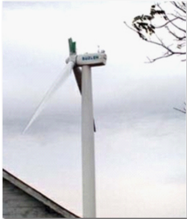
Εικόνα 3: Αποκοπή πτερού ανεμογεννήτριας στο Ιλλινόις των ΗΠΑ, το οποίο προσγειώθηκε σε απόσταση 45 m από την βάση του πύργου (Πηγή: Ragheb, 2011)
