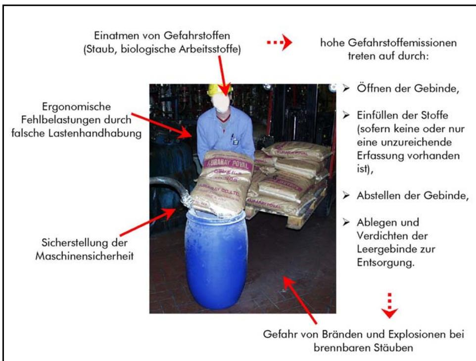
Abbildung 1: Gefährdungen beim manuellen Abfüllen und Abwiegen staubender Produkte
