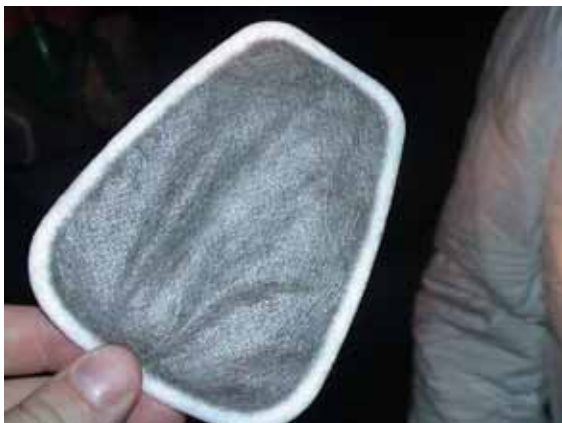
Εικόνα 2. Φίλτρο μέσου ατομικής προστασίας εργαζομένου μετά από χρήση 1 ώρας.
