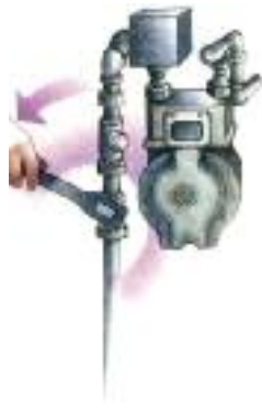
Κλείσιμο βαλβίδων μηχανημάτων
