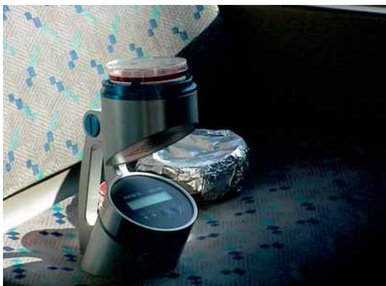
Το όργανο κατά τη δειγματοληψία εντός του οχήματος
