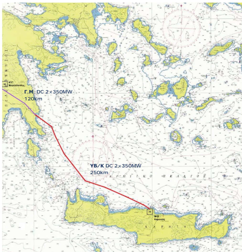
Σχήμα 13: Διασύνδεση Κρήτης με το Σύστημα – Σενάριο Α
