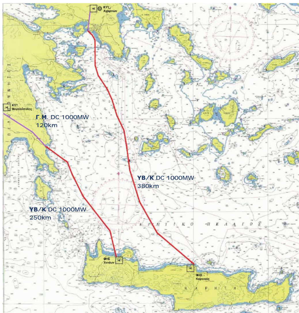
Σχήμα 19: Διασύνδεση Κρήτης με το Σύστημα – Σενάριο Γ
