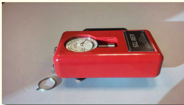
Εικ. 3: Όργανο για μέτρηση SCOF
