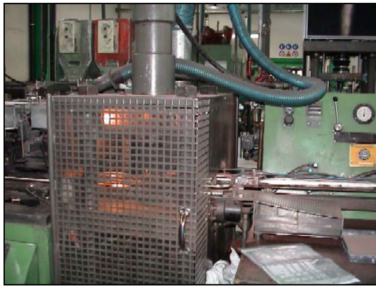
Εικόνα 3: Πρέσσα με πόρτα με σύστημα ενδομανδάλωσης
