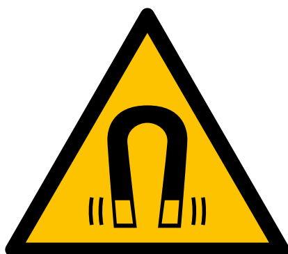
Σχήμα 7.10 — Παραδείγματα προειδοποιητικών σημάτων για ισχυρά μαγνητικά πεδία και απεικόνιση του απαγορευτικού συμβόλου για πρόσωπα που φέρουν ενεργά εμφυτευμένα ιατροτεχνολογικά βοηθήματα (AIMD)
