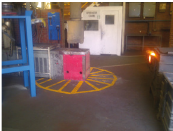
Σχήμα 8.7 — Διαγράμμιση του δαπέδου και ανάρτηση σχετικού προειδοποιητικού σήματος για τον προσδιορισμό της περιοχής στην οποία υπήρξε υπέρβαση των επιπέδων δράσης
