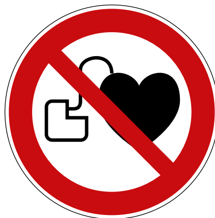
Σχήμα 7.10 — Παραδείγματα προειδοποιητικών σημάτων για ισχυρά μαγνητικά πεδία και απεικόνιση του απαγορευτικού συμβόλου για πρόσωπα που φέρουν ενεργά εμφυτευμένα ιατροτεχνολογικά βοηθήματα (AIMD)
