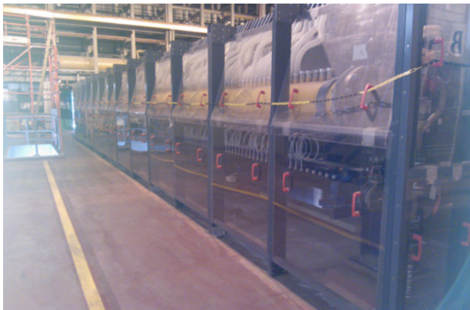
Σχήμα 3.1 — Ηλεκτρολυτικές διατάξεις στην αίθουσα κυψελών
