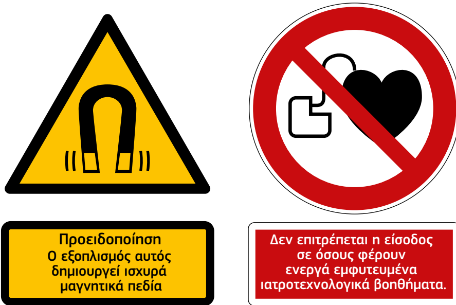
Σχήμα 4.12 — Παραδείγματα προειδοποιητικών σημάτων για ισχυρά μαγνητικά πεδία και απεικόνιση του απαγορευτικού συμβόλου για πρόσωπα που φέρουν ενεργά εμφυτευμένα ιατροτεχνολογικά βοηθήματα (AIMD)
