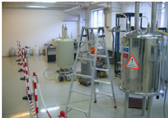
Σχήμα 2.4 — Οριοθέτηση του χώρου περιορισμένης πρόσβασης με τη χρήση αλυσιδωτού φραγμού και διαγράμμισης του δαπέδου
