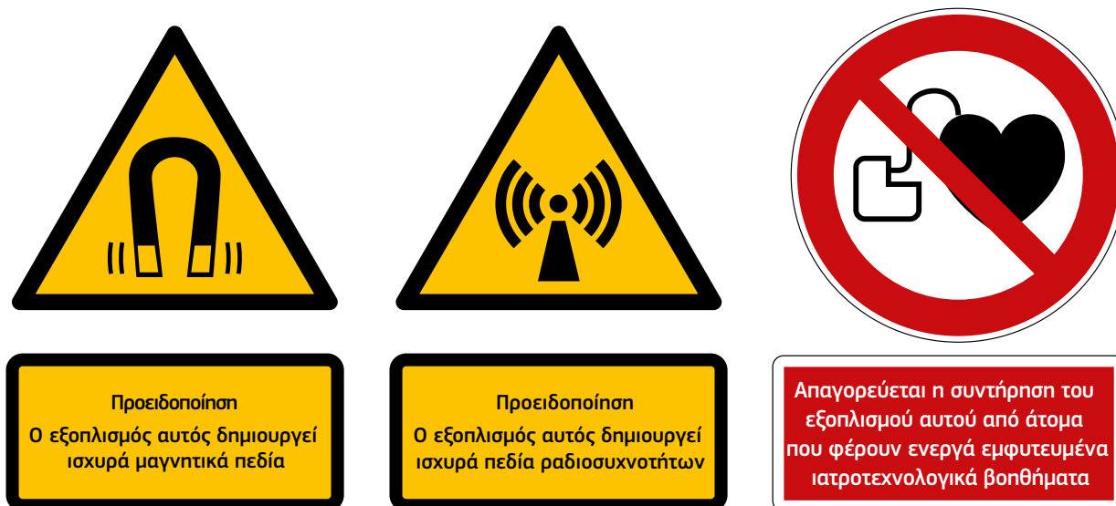
Σχήμα 9.5 — Παραδείγματα προειδοποιητικών σημάτων για ισχυρά μαγνητικά πεδία και ισχυρά πεδία ραδιοσυχνοτήτων, και απεικόνιση του απαγορευτικού συμβόλου για πρόσωπα που φέρουν ενεργά εμφυτευμένα ιατροτεχνολογικά βοηθήματα (AIMD)
