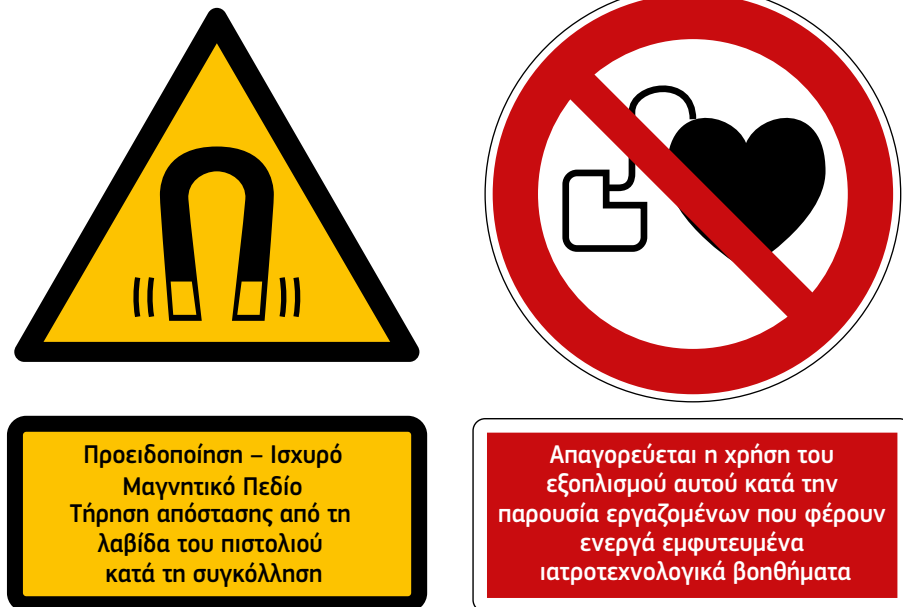
Σχήμα 6.15 — Παραδείγματα προειδοποιητικού σήματος για ισχυρά μαγνητικά πεδία και σήματος που απαγορεύει τη χρήση συσκευής συγκόλλησης από άτομα που φέρουν AIMD, ή κοντά σε αυτά
