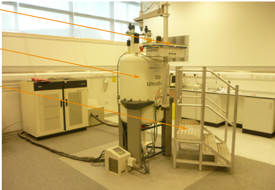
Σχήμα 2.1 — Πλήρης μονάδα NMR, με την ταινία μεταφοράς δειγμάτων και την πλατφόρμα φόρτωσης
