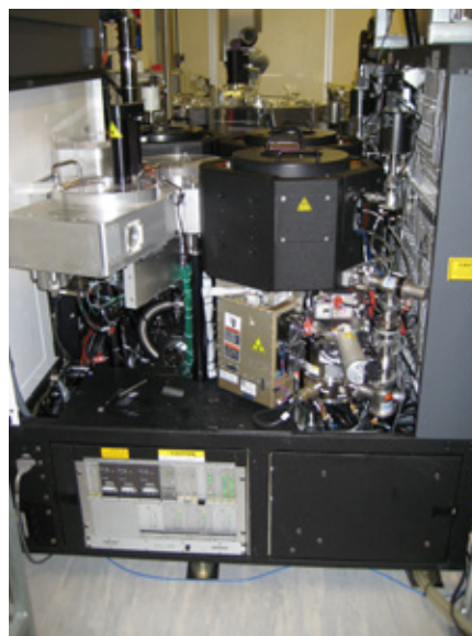
Σχήμα 9.2 — Θάλαμοι αντιδράσεων στην περιοχή συντήρησης
