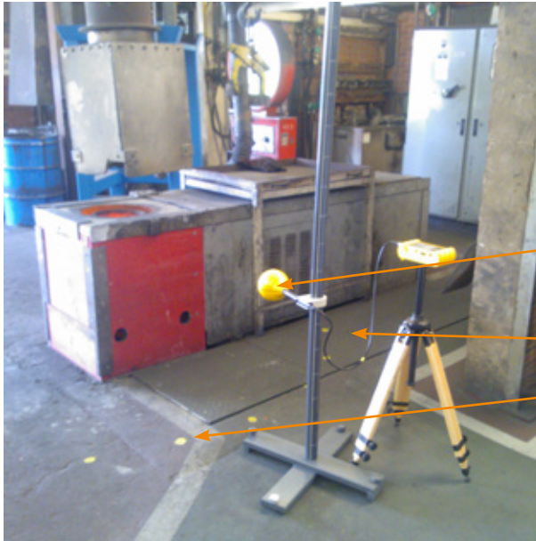
Σχήμα 8.3 — Σημάνσεις στο δάπεδο για τον προσδιορισμό της περιοχής εντός της οποίας υπήρξε υπέρβαση του υψηλού και του χαμηλού επιπέδου δράσης
