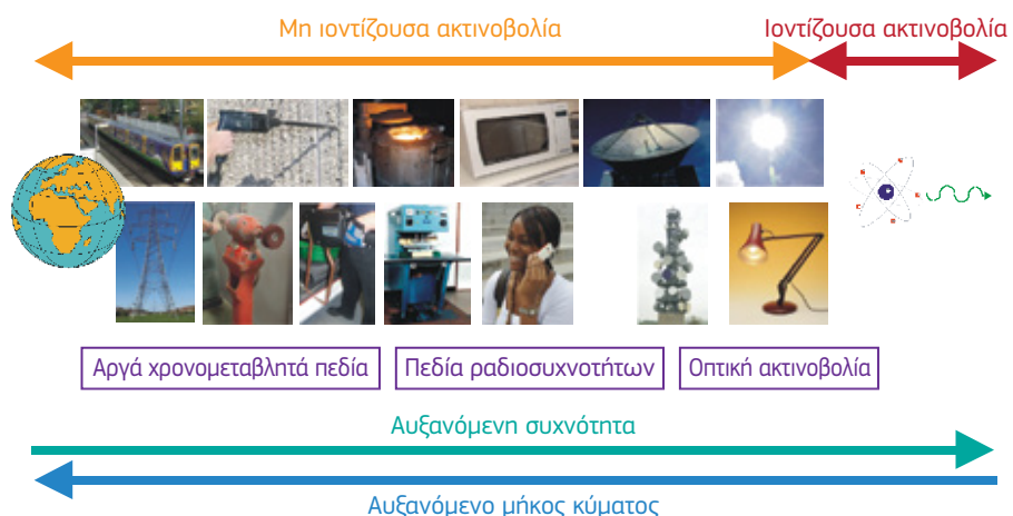
Σχήμα 3.1 — Σχηματική αναπαράσταση του ηλεκτρομαγνητικού φάσματος, που απεικονίζει μερικές συνήθεις πηγές
