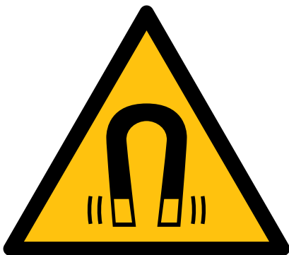
Σχήμα 9.6 — Τυποποιημένα προειδοποιητικά σήματα που χρησιμοποιούνται συχνά για τα ΗΜΠ
