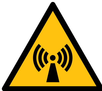
Σχήμα 9.6 — Τυποποιημένα προειδοποιητικά σήματα που χρησιμοποιούνται συχνά για τα ΗΜΠ
