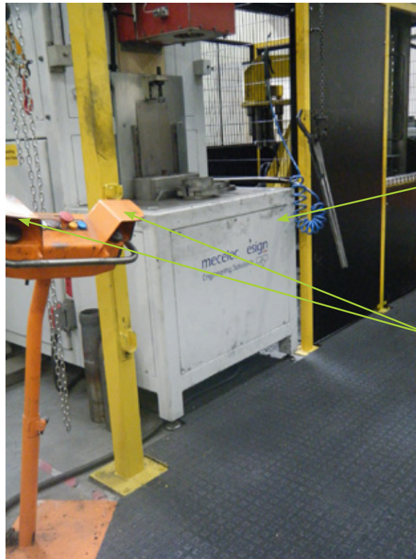
Σχήμα 9.4 — Διάταξη ελέγχου μέσω και των δύο χειρών ώστε να εξασφαλίζεται απόσταση μεταξύ εργαζομένου και επαγωγικής θερμαντικής διάταξης
