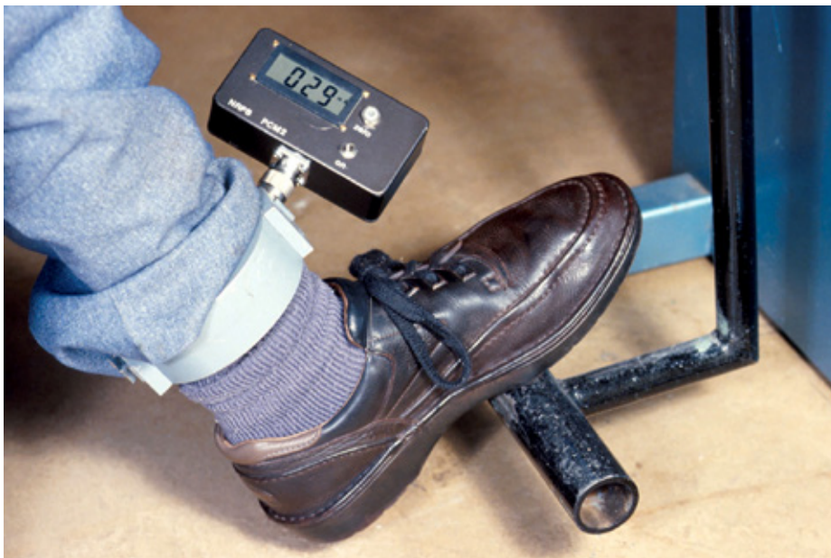
Σχήμα Γ7 — Σφιγκτήρας που μετρά σήμερα το ρεύμα άκρων όταν χρησιμοποιείται διπλεκτρικός συγκολλητής 27 MHz
